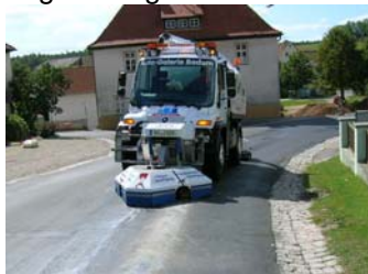
Bild 4 Fahrbahnreinigung mit einer modernen selbstfahrenden Maschine. - Hier wird mittels des Hochdruckreinigungs- Verfahrens die Fahrbahn sicher gereinigt
